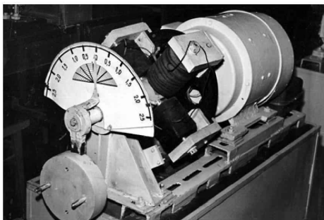
Установка для испытания электродвигателя методом непосредственной нагрузки
